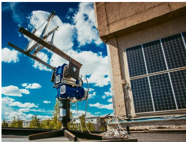
Рис.1. Поворотное устройство системы слежения за положением солнца
