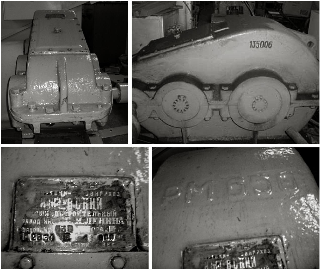
Рис.4. Редуктор РМ-650 с надписью на его крышке и заводским щитком
