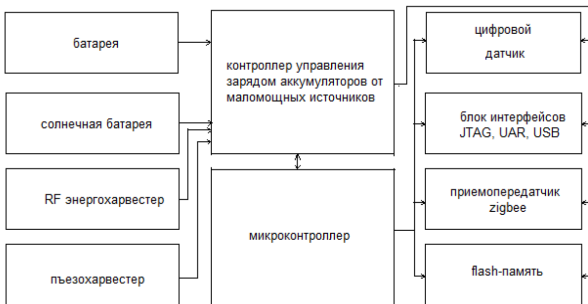
Рис.1. Структурная схема автономного беспроводного сенсорного узла
