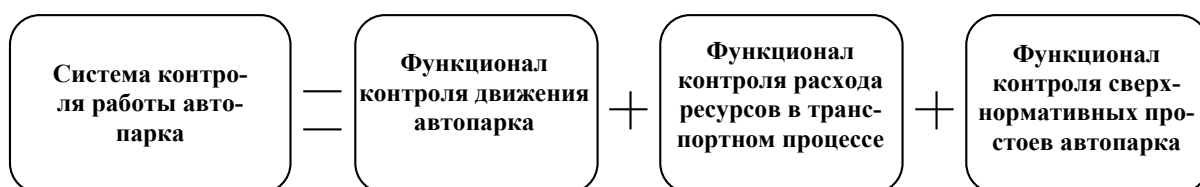
Рис.1. Концепция построения автоматизированной системы контроля работы автопарка
